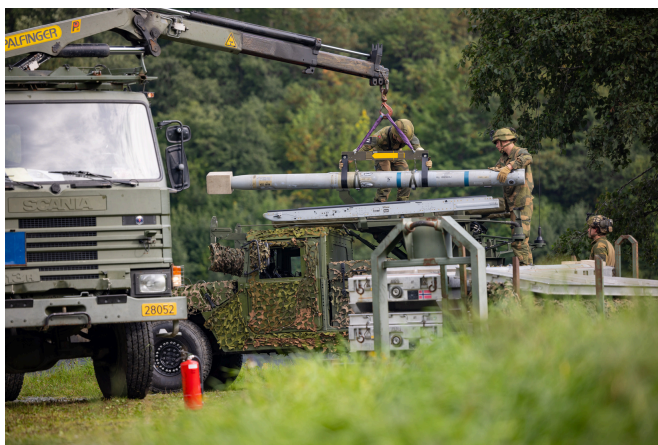
Luftvern bataljonen fra Ørland under øvelsen Nidaros Shield. Et laucherlag fyller på nye missiler på en High Mobility Launcher. Kan reservister utdannet i systemet fylle slike funksjoner? Foto: Onar Digernes Aase/Forsvaret
